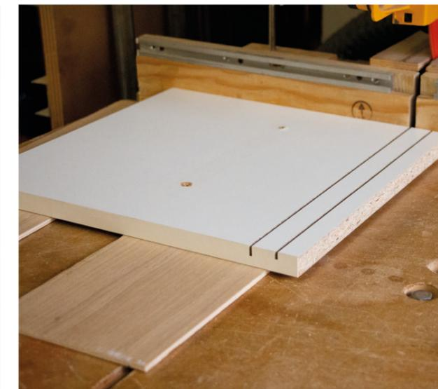
I piani delle seghe radiali tendono a rovinarsi piuttosto velocemente lungo la linea di taglio così da non fornire più supporto al materiale lungo la linea d'uscita della lama. Se con il massello il problema è relativamente importante (e condiviso con troncatrici e banchi sega), con il laminato e pannelli nobilitati in genere è necessario inserire un pannello sacrificale che impedisca al materiale di scheggiare.
