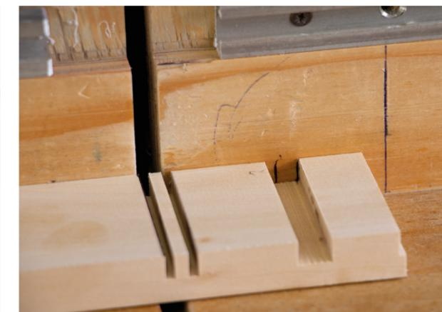
Si segna quindi la spalla sinistra del secondo canale e si effettua il relativo taglio (TAGLIO B). Ancora una volta, usando la spalla destra del primo canale, si traccia una linea sulla battuta verticale. Questo è il SEGNO 2 e si troverà a destra del primo.
