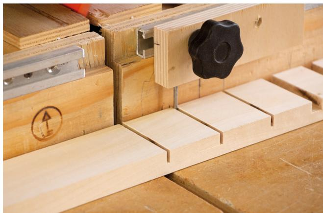
Utilizzando il terminale come indice per spostare il pezzo, si eseguono tutti i TAGLI A (ovvero le spalle destre). Da questo momento in poi inizia la produzione "automatizzata" che consente anche, senza dover effettuare nuove misurazioni, di iniziare a lavorare le stecche successive alla prima.
