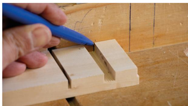
Con la lama alzata in modo da scendere un poco (0,5mm) oltre metà spessore del materiale si realizzano un canale ampio quanto dovrà essere la larghezza dei listelli ed un taglio (TAGLIO A) che definisce contemporaneamente la spalla destra degli scassi e la grandezza dei fori della griglia. Senza spostare il pezzo dopo l'ultimo taglio, si segna la posizione della spalla destra del primo canale sulla battuta verticale. Si ottiene così il SEGNO 1.
