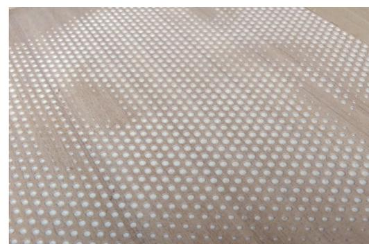
La lavorazione per punti è un continuo sali e scendi sull'asse Z. Impostare un sorvolo basso è fondamentale per contenere i tempi della lavorazione. Nel nostro caso la separazione di 2 mm e il feed di 2,5 m/min ci hanno permesso di terminare la riproduzione in 25 min. Qui il risultato è ottimo, la fresatura risulta pulita sia nel piallaccio, sia nel pioppo.
