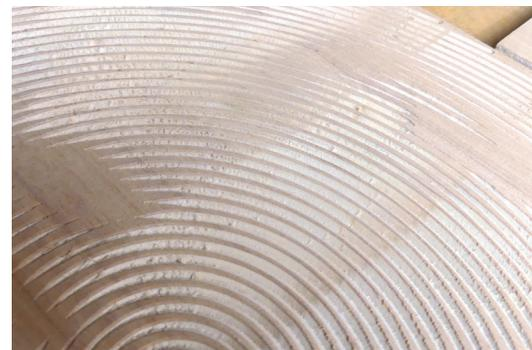
La fresatura per cerchi concentrici parte dal centro e pian piano prosegue verso l'esterno. Nelle prime due immagini si nota l'omissione di un arco nella fresatura, causata da un errore di programmazione. Scoprendo poi il pioppo del supporto, sono emerse delle vene più scure con andamento verticale in prossimità degli occhi; una caratteristica non voluta, ma fa parte del legno e dona particolarità a questa riproduzione.
