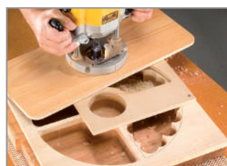
Terminez la partie intérieure du plateau avec la fraise et le mandrin.
