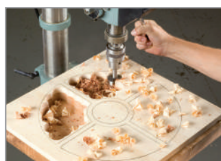
Utilisez une mèche Forstner de 50,8mm pour enlever le plus de matériau possible du plateau.
