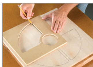
Tracez la forme dans le gabarit.
