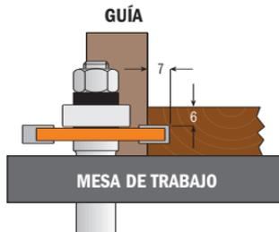
**FASE 5:** Vuelva a utilizar la fresa circular de 6mm. frese la ranura en la orilla del frente del cajón o la puerta.
