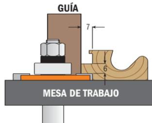
**FASE 4:** Emplee nuevamente la fresa circular para ranuras de 6mm. con la guía colocada a 7mm. de profundidad. Con esta pasada tenemos que variar la altura de la herramienta hasta obtener un canto de 6mm. de espesor.
