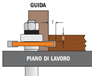
**FASE 5:** ora riutilizzate la fresa a disco da 6mm per fresare la scanalatura sulla costa del fronte del cassetto o dell'antina.
