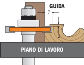
**FASE 3:** ora abbassate la fresa di 2mm verso il piano di lavoro e posizionate la guida ad una profondità di taglio di 7mm. Con tale operazione si otterrà un dente di 2mm come da illustrazione che coprirà la costa del fronte del cassetto o dell'antina, migliorerà esteticamente e guadagnerà anche in robustezza.
