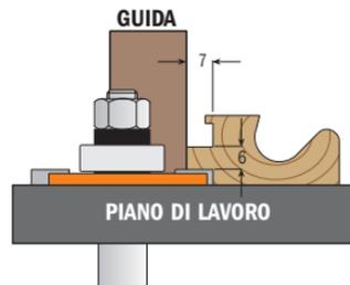
**FASE 4:** impiegate nuovamente la fresa a disco per scanalature da 6mm con la guida disposta per 7mm di profondità. Con questa passata l'altezza dell'utensile deve essere variata fino ad ottenere un tenone da 6mm di spessore.
