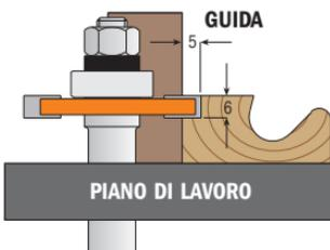
**FASE 2:** utilizzate una fresa a disco per scanalature da 6mm con una guida posizionata per una profondità di taglio da 5mm. Questa passata forma il solco principale del tenone.
