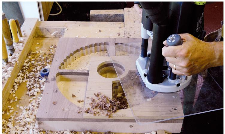
Al final asegúrese de que el rodamiento de la fresa se mueva a lo largo del molde para garantizar una primera pasada eficaz. Si tiene, inserte la boca para el polvo antes de trabajar.
