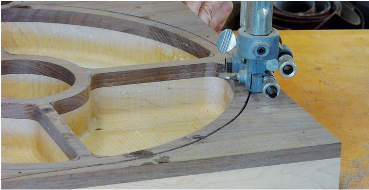
Verwenden Sie eine Bandsäge, um der Linie entlang zu schneiden, danach entfernen Sie das Tablett aus dem gearbeiteten Holzblock. Bearbeiten Sie langsam, um eine hochpräzise Arbeit zu erzielen und eventuelle Besandung zu vermeiden.
