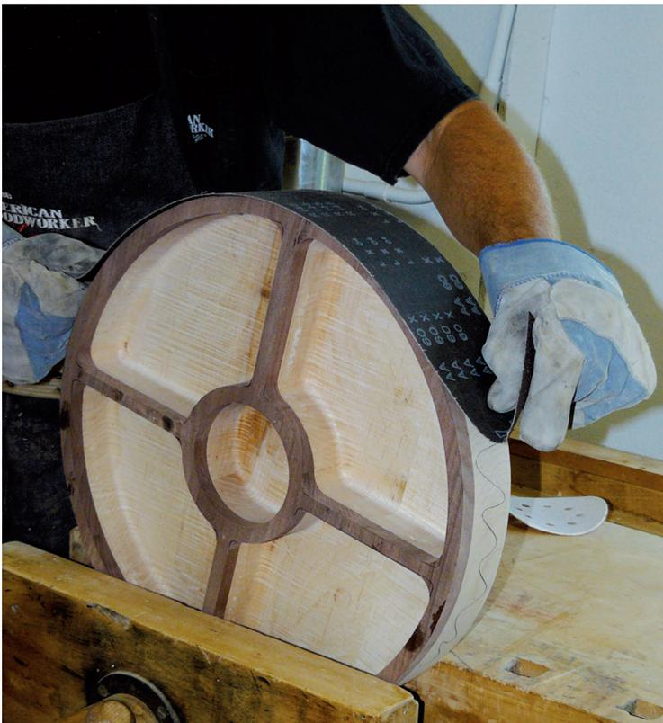
Als Alternative, wenn Sie schneller arbeiten möchten, können Sie eine Schleifscheibe zum Schleifen benutzen, aber achten Sie darauf, dass Sie dabei die Innenseite des Tablett beschädigen könnten. Ansonsten können Sie einen Exzentrerschleifer verwenden.
