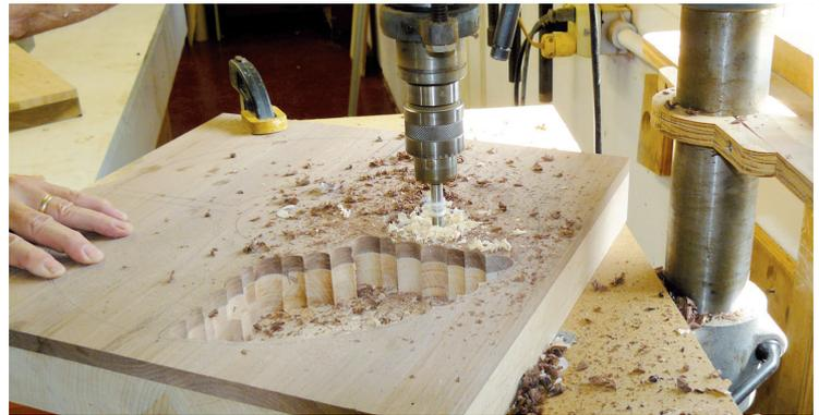
Quite el máximo material posible del bloque utilizando una broca Forstner en un taladro de columna. Taladre hasta una distancia de 3,2mm de las marcas dibujadas y ajuste la profundidad de taladro para evitar tocar el fondo de la bandeja. Los desechos de materiales dejados por la broca serán quitados por la fresa para bandejas incluida en el embalaje.
