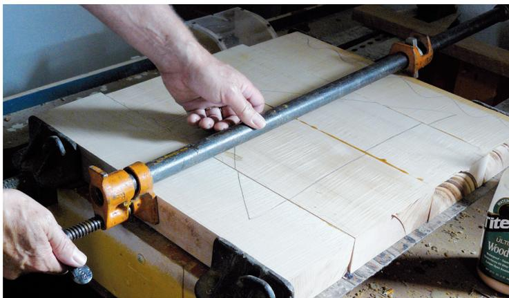
Usted podrá fabricar el bloque y la parte superior en maderas diferentes, para que así tenga un contraste visual agradable. Alinee bien las piezas antes de pegarlas, para garantizar un buen apriete del bloque sin necesidad de lijarlo, en particular para los bloques de laminados o de otro tipo de madera, como puede ver en la imagen.
