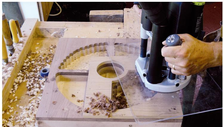
Achten Sie darauf, dass das Kugellager dem Schablonenbord entlang gleitet, um einen effizienten Durchgang zu garantieren. Setzen Sie das Entstaubungssystem in die Oberfräse, falls Sie eines zur Verfügung haben.
