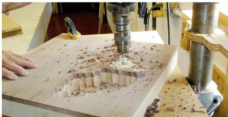
Enlevez le plus de matériau possible du bloc en utilisant une mèche Forstner montée sur une perceuse à colonne. Percez jusqu'à une distance de 3,2mm des lignes tracées et ajuster la profondeur de coupe pour éviter d'entrer en contact avec le fond. Les déchets de matériau seront enlevés par la fraise pour plateaux incluse dans le kit.
