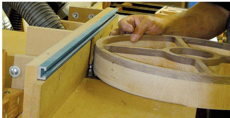
Una volta coperti i segni della fresatura ed effettuata la levigatura, passate al tavolo da lavoro per il tocco finale. installate una fresa a raggio concavo da 12,7mm, passate il vassoio per smussarne i bordi inferiori.
