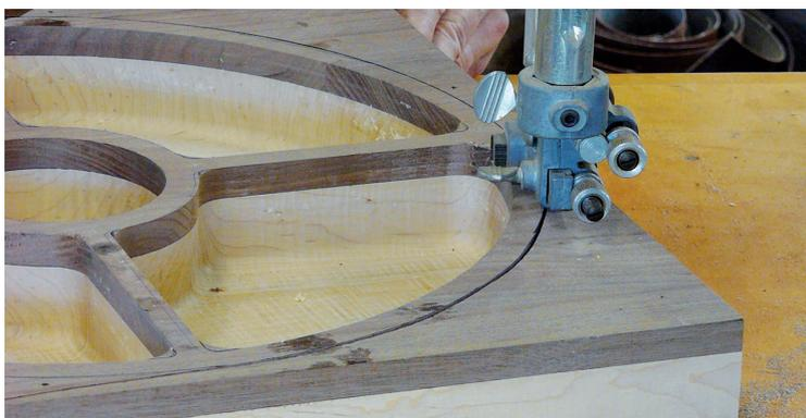
Utilizzate una sega a nastro per tagliare lungo la linea tracciata ed estraete il vassoio dal massello lavorato. Lavorate lentamente per ottenere il massimo della precisione, in modo da evitare eventuali levigature.
