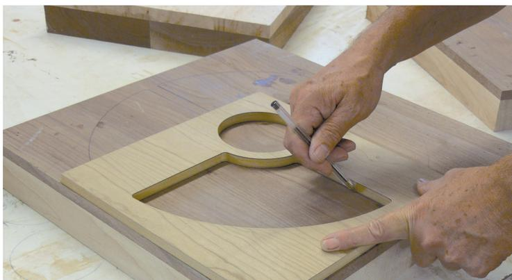
Posicione el molde sobre la parte central del bloque y dibuje el primer cuadrante como en la imagen. Quite el molde y dibuje un signo a 12,7mm del borde marcado para definir el espesor de la bandeja. Es importante crear todos los cuadrantes iguales. Alinee el molde a las marcas para crear los otros cuadrantes, así que se reproduzca la forma de una bandeja.
