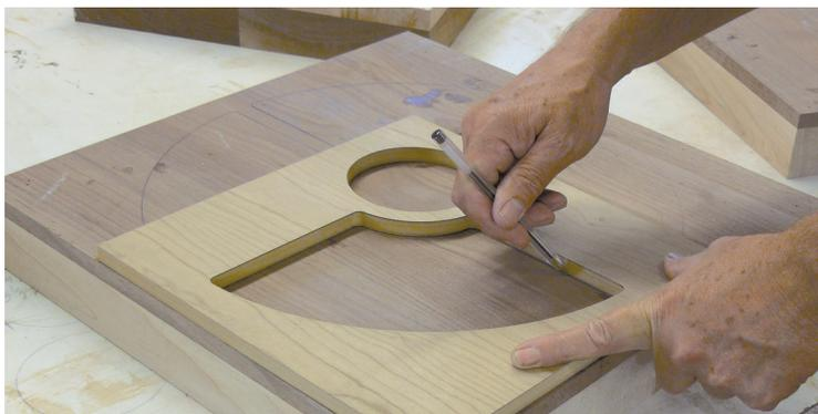
Zentrieren Sie die Schablone auf dem Block und zeichnen Sie den ersten Quadrant, wie das Bild anzeigt. Entfernen Sie die Schablone und zeichnen Sie eine Marke 12,7mm vom Bord auswärts. Bitte bearbeiten Sie langsam und deutlich, um regelmäßige Quadranten zu erzeugen. Bitte orientieren Sie sich an der vorher gezeichneten Marke, um die Schablone auszurichten und stellen Sie die andere Quadranten her, sodass Sie die Form eines Tablett insgesamt abbilden.
