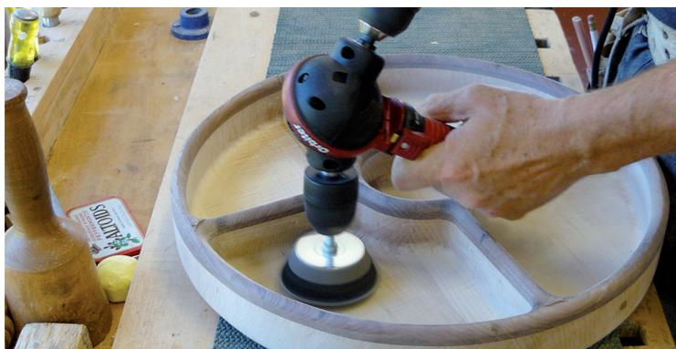
Lissez la partie intérieure des quadrants avec un disque abrasif. Ces disques-ci sont communément utilisés par les tourneurs pour lisser les plateaux en bois. Commencez à lisser avec une superficie abrasive de 80 grains de finesse, jusqu'à arriver, si nécessaire, à 220 grains. Enfin huilez le plateau avec huile de noix (non-toxique et qui sèche rapidement), huile minérale ou gomme laque.
