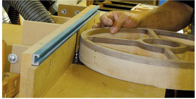
Wenn Sie mit der Besandung fertig sind, gehen Sie zum Tisch für den letzten Schliff. Setzen Sie einen 12,7mm Radiusfräser ein, dann fräsen Sie die untere Außenseite des Tablett wie das Bild anzeigt.
