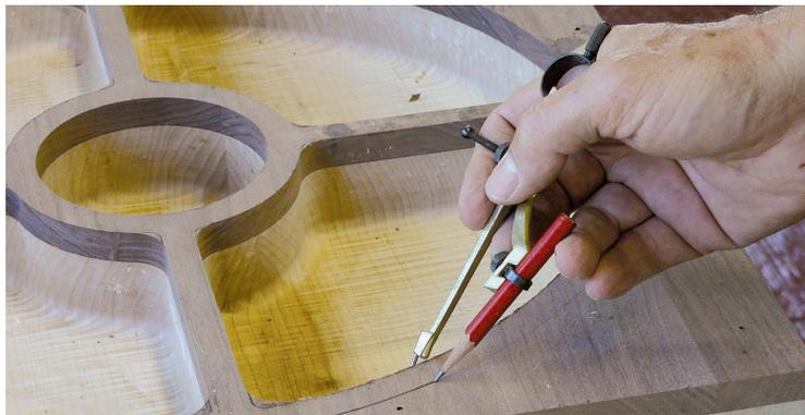
Ahora usted tiene que dibujar el espesor de la bandeja. Utilice un compás para dibujar una circunferencia a una distancia de 12,7mm del borde. La punta del lápiz tendrá que estar 6,35mm delante la punta del compás. Posicione el compás como en la imagen poniéndolo perpendicular y dibuje una línea alrededor del bloque. Si la superficie alrededor de la bandeja no fuera uniforme, ponga una pieza de madera fina al lado del borde para dibujar la circunferencia sin dificultades.
