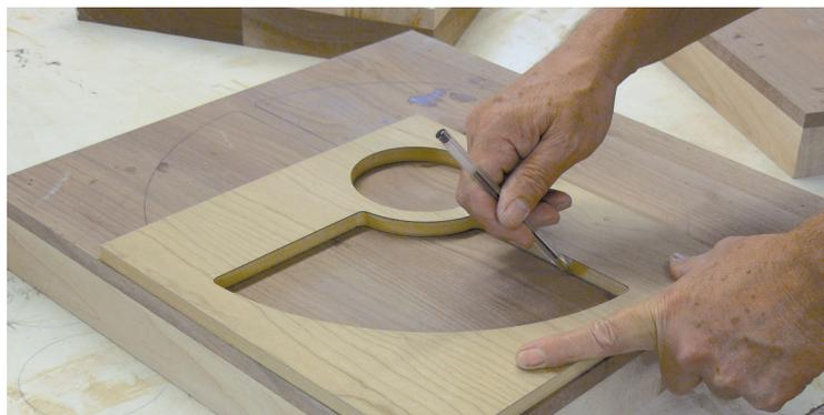
Centrate la dima sul massello e tracciate il primo quadrante come da figura. Rimuovete la dima e tracciate un segno a 12,7mm dal bordo del quadrante verso l'esterno per definirne lo spessore. E' importante essere precisi per ottenere uniformità tra tutti i bordi dei quadranti. Fate riferimento ai segni tracciati per allineare la dima e riprodurre anche gli altri quadranti, in modo che venga complessivamente riprodotta la forma di un vassoio.
