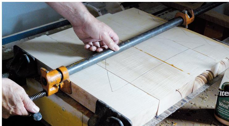
Fabriquez le bloc et la partie supérieure avec différentes essences de bois pour obtenir un bon contraste visuel. Il est important d'aligner les pièces de bois qui formeront le bloc avant le collage pour garantir un serrage optimal sans effectuer de lissage après. Cela s'applique particulièrement aux blocs de laminés ou stratifiés particuliers, comme l'image le montre.
