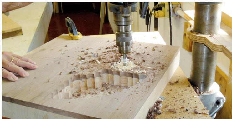
Rimuovere più materiale possibile dal massello utilizzando una punta Forstner su trapano a colonna. Forate fino ad una distanza di 3,2mm dalle linee tracciate e regolate la profondità di taglio in modo da evitare il contatto con il fondo. I residui di materiale lasciati dalla punta verranno poi rimossi dalla fresa per vassoi inclusa nel kit acquistato.
