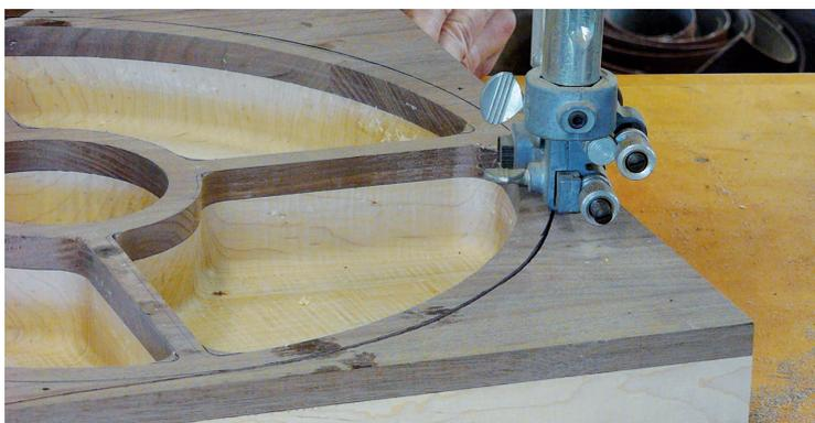
Use una sierra de cinta para cortar a lo largo de la línea dibujada y quite la bandeja del bloque trabajado. Trabaje cuidadosamente para evitar lijados y obtener una bandeja uniforme. La bandeja necesita ahora trabajo adicional.
