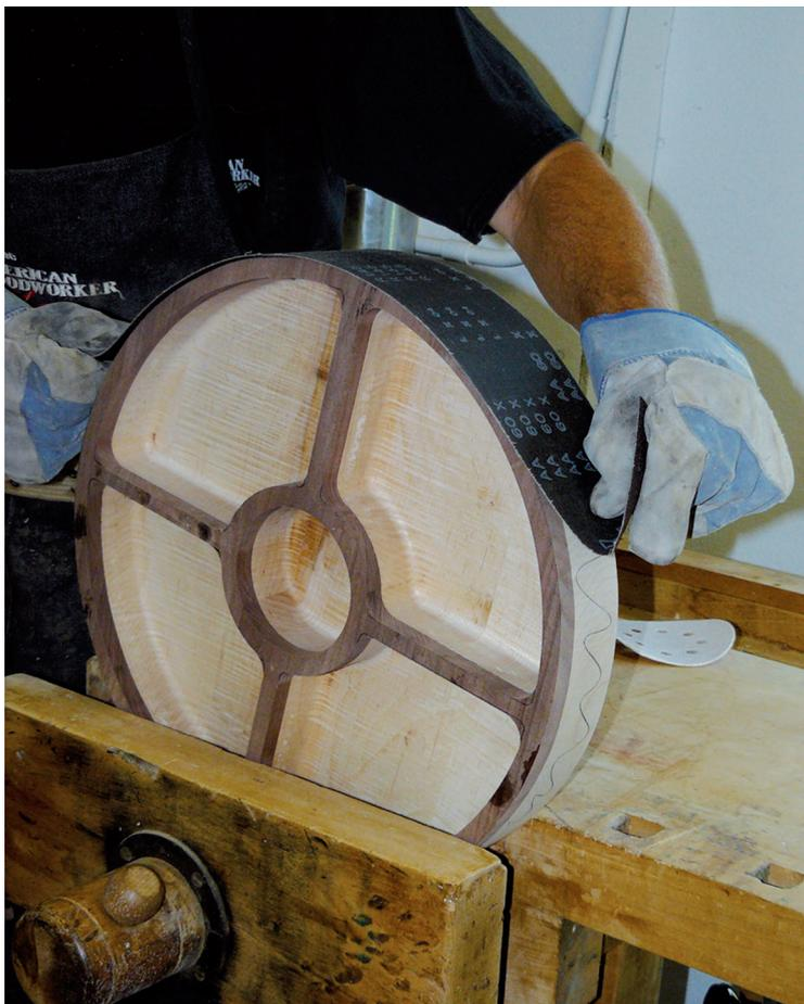
La plaque que vous aurez enlevé nécessitera d'être poncé sur la partie extérieure, par exemple en utilisant une bande de ponçage. Placez celui-ci sur les marques données par le crayon et lissez. Serrez le plateau dans un étau (placez des déchets du bois sur les mâchoires pour éviter de l'abimer) et lissez-le comme l'image le montre.
