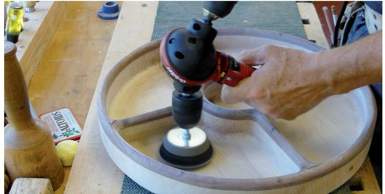
Schleifen Sie die Innenseite der Quadranten mit einer Schleifscheibe. Normalerweise werden diese Scheiben von Drechslern benutzt, um Holztablett zu glätten. Fangen Sie an mit einer abrasiven Oberfläche verschiedener Feinheit, beginnend mit 80 Körner bis zu 220 wenn nötig. Schleifen Sie die Außenseite des Tablett mit einem Exzentrerschleifer. Zuletzt nassen Sie das Tablett mit Walnussöl (ungiftig und sich schnell trocken), Mineralöl oder Schellackdurch. Sie sind fertig!
