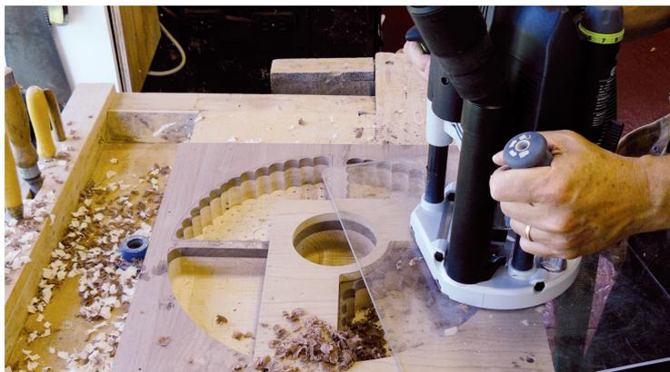
Enfin, assurez-vous que le roulement de la fraise se déplace le long du gabarit pour obtenir un premier passage efficace. Si vous le possédez, insérez le tuyau d'aspiration des copeaux avant de commencer à travailler.
