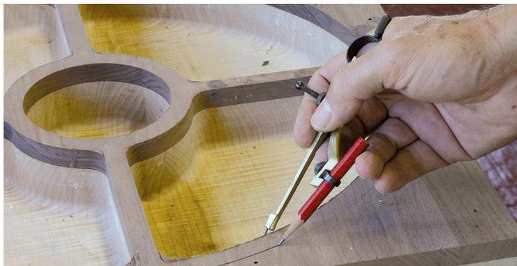
L'étape suivante consiste à tracer le contour du plateau. Tracez un cercle à 12,7mm de distance du bord du plateau avec un compas. La pointe du crayon devra rester environ à 6,35mm devant la pointe du compas. Bloquez le compas comme l'image le montre en le tenant perpendiculaire et tracez une ligne autour du bloc. Si le bloc n'est pas uniforme, placez une pièce de bois à côté du bord du plateau pour tracer le contour sans problème.
