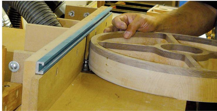
Cuando esté listo con el lijado, utilice una fresa de radio cóncavo de 12,7mm en una mesa de trabajo para el toque final. Bisele el borde inferior de la bandeja.
