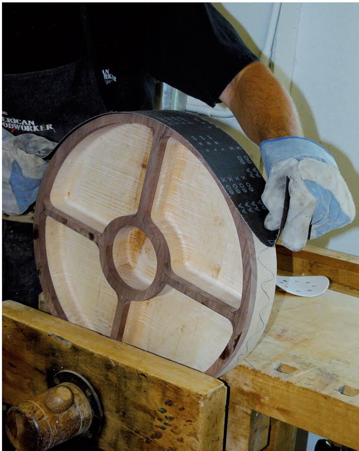
Lije la parte exterior, por ejemplo empleando una cinta de lijado. Lije las marcas dejadas por el lápiz. Apriete la bandeja en una abrazadera (ponga desechos de materiales entre la bandeja y las morzadas para evitar estropear la bandeja) y líjela como en la imagen.
