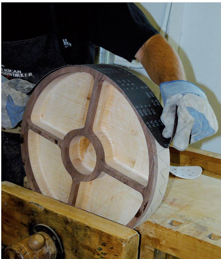
l'esterno, ad esempio utilizzando del nastro abrasivo. Prendete come riferimento i segni lasciati dalla matita per effettuare quest'operazione. Serrate il vassoio in una morsa (Inserite scarti di legno sulle ganasce della morsa per evitare di rovinarlo) e levigatelo come da figura.
