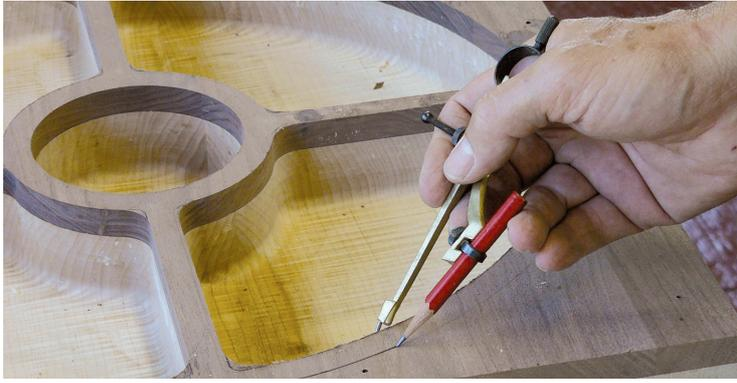
Schalten Sie Ihre Oberfräse aus und stellen Sie sicher, dass der Fräser angehalten hat, bevor Sie ihn aus dem Tablett wegnehmen. Wiederholen Sie das beschriebene Verfahren mit alle Quadranten und mit dem Loch in der Mitte des Tablett.
